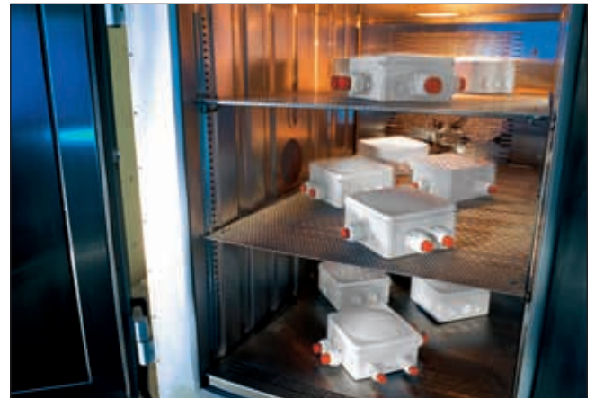
Climatical testing of junction boxes Abzweikästen im Klimatest
